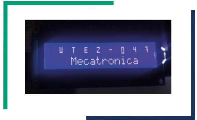
Figura 4. Pantalla LCD 16x2, ejemplo de la práctica I2C con aplicación a LCD
