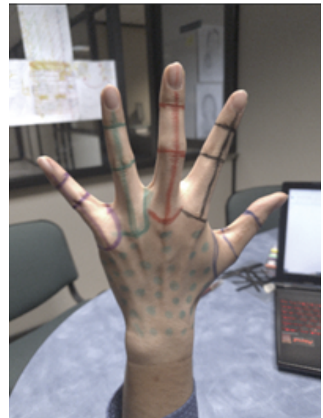
Figura 2. Mano utilizada para las pruebas de fotogrametría con los patrones para la detección de rasgos
