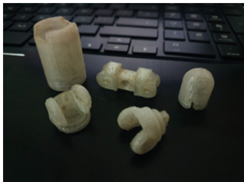
Figura 5. Piezas del prototipo de prótesis impresas con FDM
