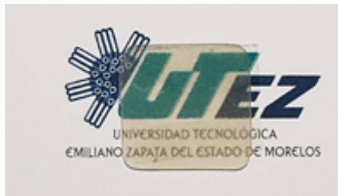
Figura 2. Bioplástico nanoestructurado a base de maíz plastificado con glicerina.
