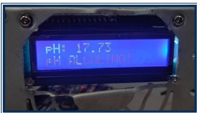
(b) Display desplegando el valor del pH. Figura 9. Circuitos eléctricos implementados.
